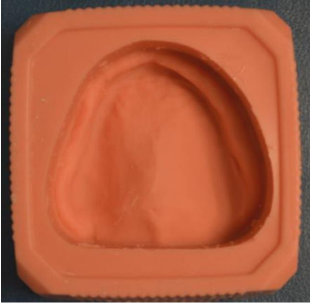
Abb. 8: Doublrierform zur Vervielfältigung der Meistermodelle
