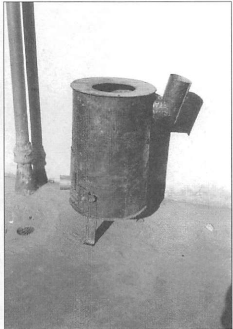
Foto 9: Chokey bukhari - Metallofen. Chokey bukhari - iron fuelwood oven. Aufnahme/photograph: J. Clemens, Sept. 1991.
