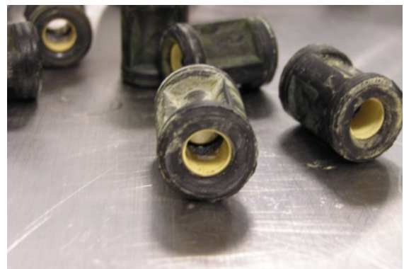
Abb. 7: Ausgebaute Schalldämpfer zur Abstrichuntersuchung
