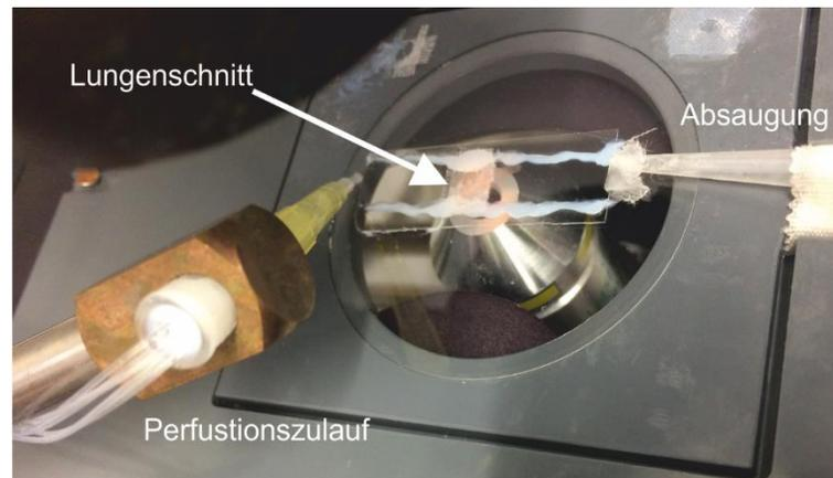
**Abb. 7: Perfusionskammer mit Lungenschnitt während der Messung.** Der Lungenschnitt wurde unter einem Nylonnetz zwischen zwei Deckgläsern fixiert. Durch eine kontinuierliche Perfusion konnten verschiedene vasoaktive Substanzen appliziert werden.
