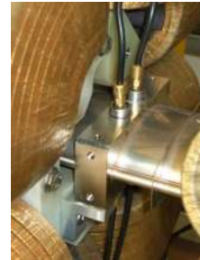
(b) Foto einer Quadrupolstrahlkammer mit integriertem Strahllagemonitor. Zu erkennen sind die vier Kabel, die an den Knopfelektroden angebracht sind.
