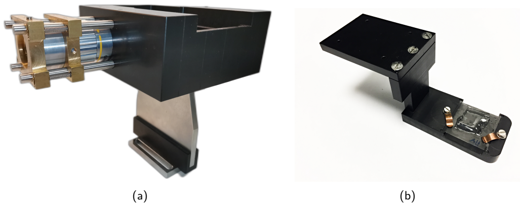
Abbildung 4.5: (a) Seitliche Ansicht der Probenkammer: Die Kammer wurde so konstruiert, dass die vordere Glasfront der Objektive im direkten Kontakt mit der Flüssigkeit in der Probenkammer ist. (b) Foto des Probenhalters: Die Probe wird auf einem Deckglas befestigt, welches über zwei Klemmen auf dem Probenhalter fixiert wird. Der Probenhalter haftet mit Magneten an den Motoren.
