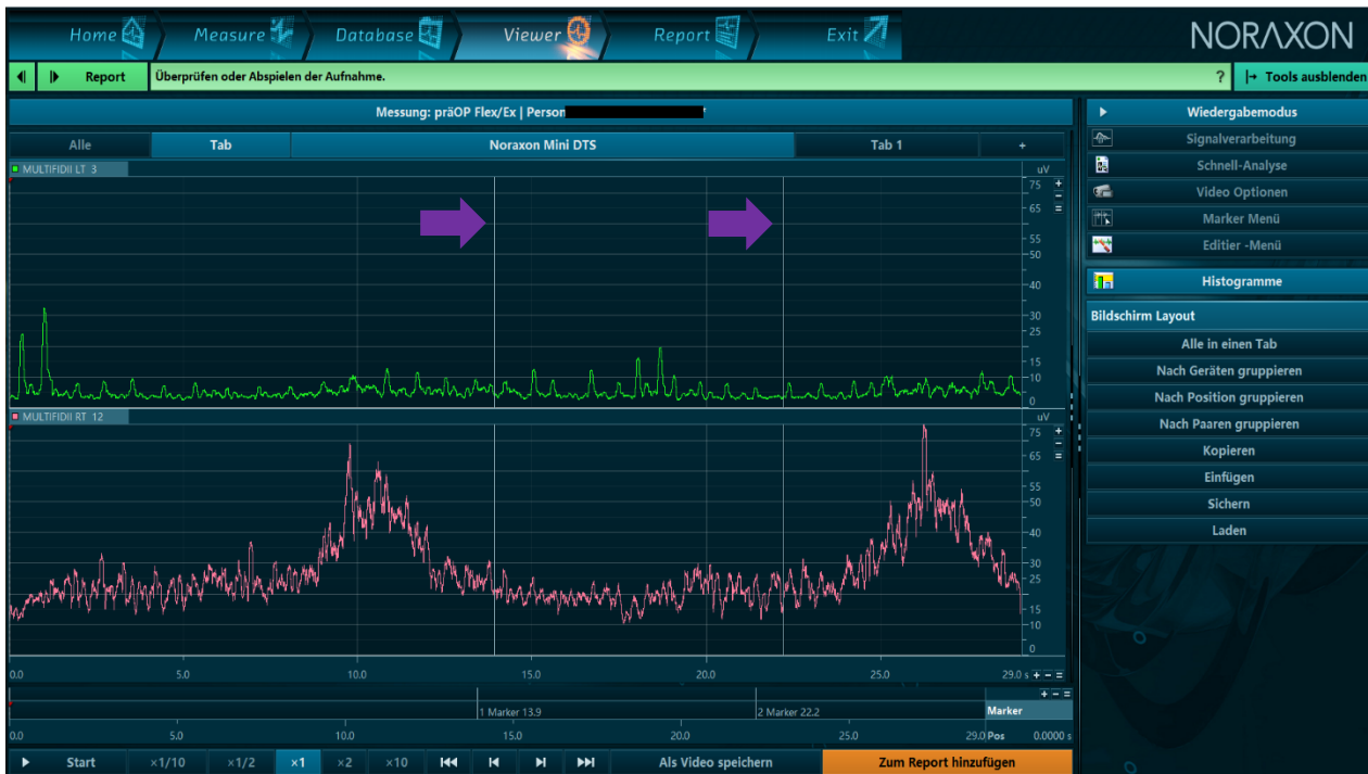
Abb. 17: Beispielhafter Screenshot der RMS-EMG-Signale während der Flexions-Relaxations-Messung. Grün: Amplitude linker M. multifidus. Rot: Amplitude rechter M. multifidus. Lila Pfeile: digitale Marker zu Beginn des Analysezeitraums.
