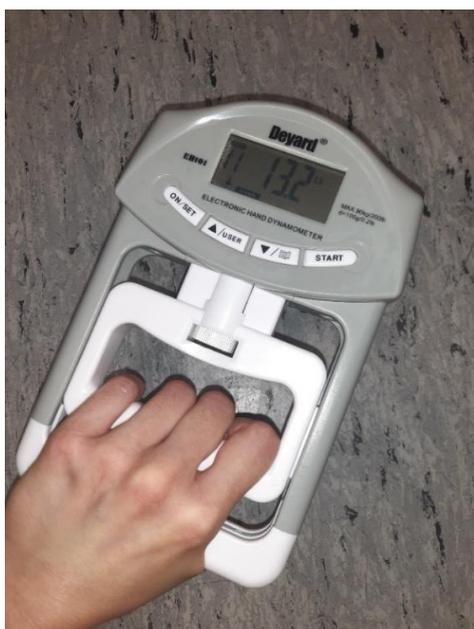
**Abb. 6:** Handkraftmessgerät
