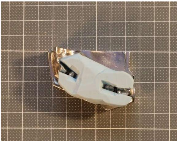
**Abb. 4:** Positionierungshilfe zur Einbringung und Fixierung der langen Verstärkungen dargestellt auf dem Produktionsmodell
