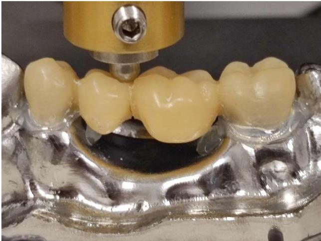
**Abb. 8:** Angepasster Versuchsaufbau in der Situation eines durchgeführten Vorversuchs ohne Zinnfolie.
