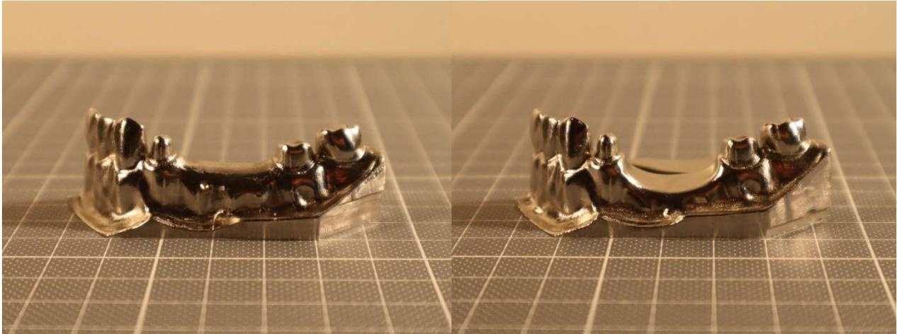
**Abb. 2:** Das Produktionsmodell zur Herstellung der Proben (links); das Prüfmodell zur Durchführung der Bruchversuche (rechts).
