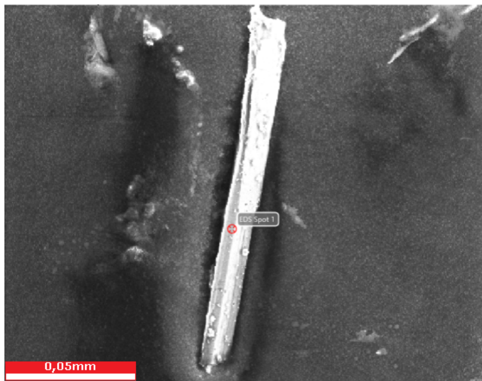
Abbildung 85: Rasterelektronenmikroskopaufnahme des vermessenen Kristalls von TiV_2(S_2)_3(PS_4) .
