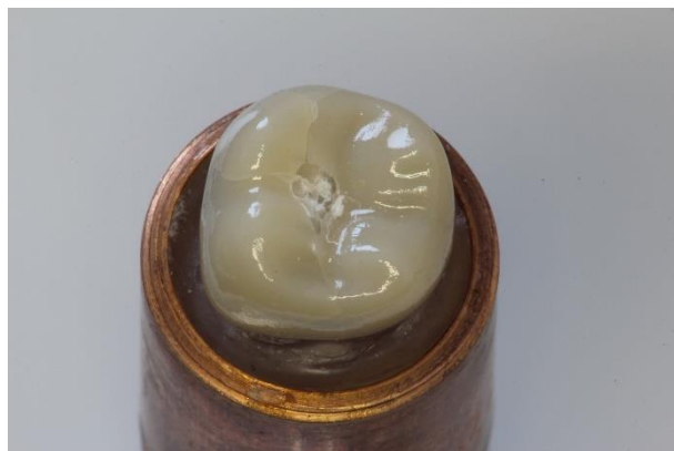
Abb. 34: Probe K28 nach Dauerbelastung: Hier (420 N, 60 %) kam es zu einer deutlichen Rissbildung in der Krone, die bei einer optischen Kontrolle nach 2854 Zyklen bemerkt wurde.
