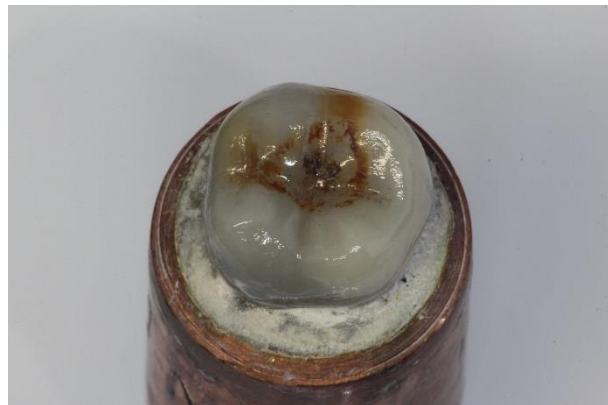
Abb 18: Probe M17 nach Dauerbelastung: Diese Probe überstand bei 600 N (20 %) 2 Mio. Zyklen erfolgreich. Im Auflagebereich des Druckstempels sind Abnutzungerscheinungen ersichtlich. Die Braunfärbung der Krone entstand durch Rostablagerungen des Druckstempels.
