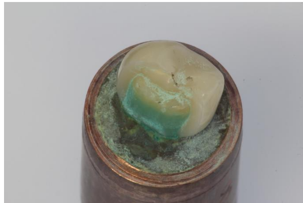
Abb. 42: Probe H28 nach Dauerbelastung: Hier kam es nach anfänglichen Positionierungsschwierigkeiten bei 480 N (60 %) nach 3050 Zyklen zum Bruch der Krone. Durch eine Reaktion des Kupfers ist eine deutlich sichtbare grün-bläuliche Verfärbung auf dem Zahn entstanden.
