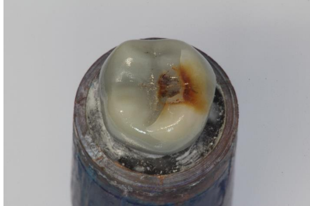
Abb. 22: Probe M33 nach Dauerbelastung: Bei 500 N (20 %) wurde, nachdem die Probe 2 Mio. Zyklen durchlaufen hatte, ein deutlicher, sich von okklusal auf die vestibulären Flächen ausbreitender, Riss bemerkt.
