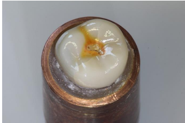
Abb. 35: Probe K30 nach Dauerbelastung: Bei 140 N (20%) wurde nach 515962 Zyklen ein Riss in der Krone bemerkt. Wahrscheinlich ist diese im Bereich zwischen 400000 und 450000 Zyklen aufgetreten.
