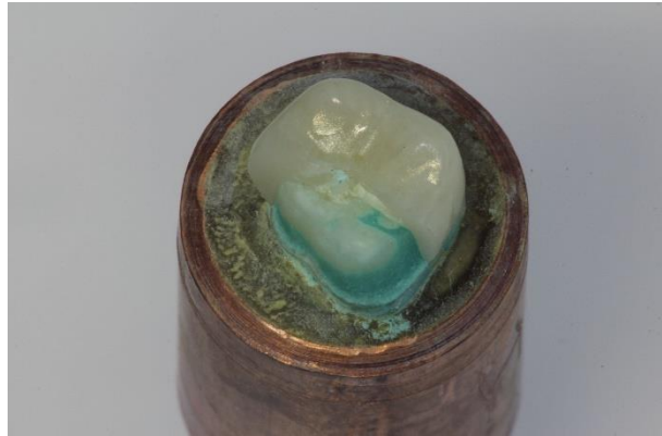
Abb. 38: Probe H8 nach Dauerbelastung: Bei 900 N (60 %) kam es nach 371 Zyklen zum Bruch der Krone.
