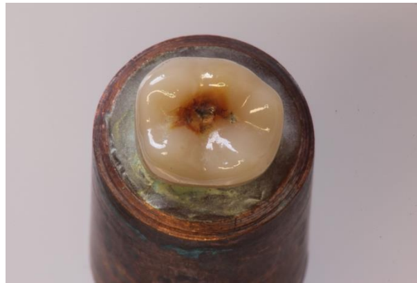
Abb. 43: Probe H27 nach Dauerbelastung: Bei 320 N (40 %) überstand sie die 2 Mio. Zyklen unbeschadet. Auch hier wurden die okklusalen Abnutzungserscheinungen im Auflagebereich des Druckstempels vernachlässigt.
