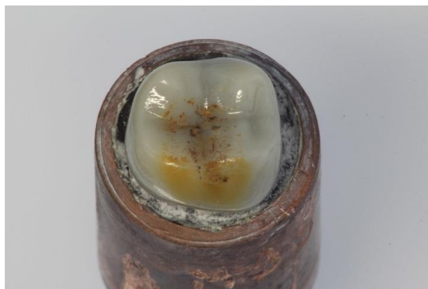
Abb. 24: Probe M39 nach Dauerbelastung: Bei 400 N hat sie 2 Mio. Zyklen komplett unbeschadet überstanden.
