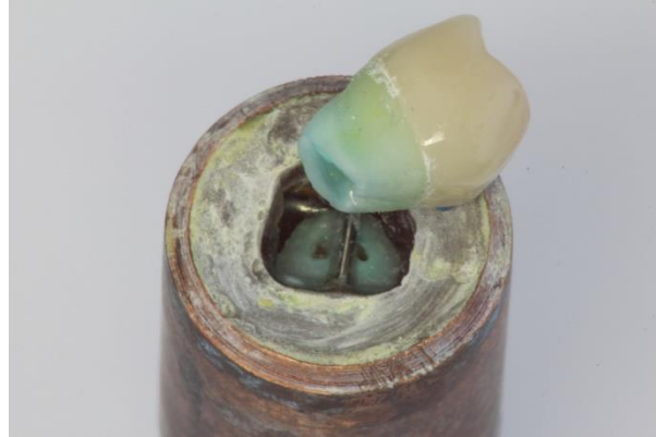
Abb. 45: Probe H40 nach Dauerbelastung: nach 60011 Zyklen frakturierte die Wurzel. Diese Probe wurde daher von der Wertung ausgeschlossen.
