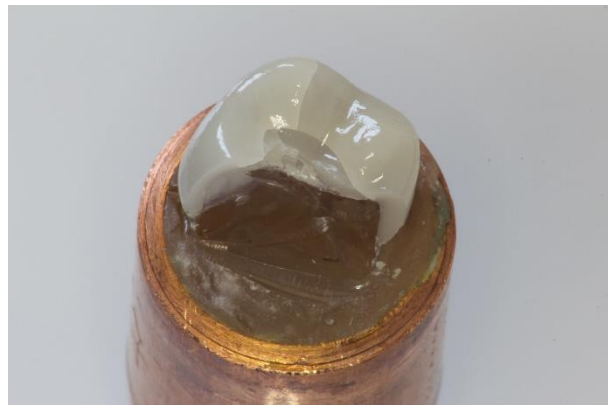
Abb. 28: Probe K7 nach Einschwingen: Bei einer Kraft von 800 N (80 %) kam es beim Einschwingen zum Bruch der Krone, sowie des darunterliegenden Stumpfes.
