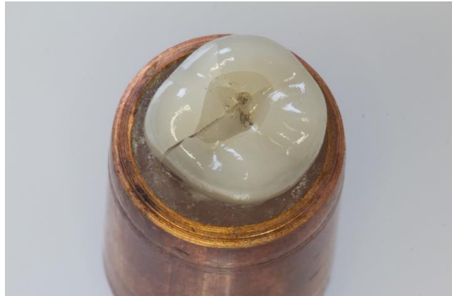
Abb. 30: Probe K15 nach Dauerbelastung: In der Krone zeichnet sich bei 400 N (40 %) ein deutlicher Riss in der Krone ab, der sich im Stumpf fortsetzt. Dieser wurde bei 15265 Zyklen bemerkt, fand jedoch laut Versuchsprotokoll bei ca. 7000 Zyklen statt.
