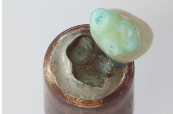
Abb. 40: Probe H10 nach Dauerbelastung: Bei diesem Oberkiefermolaren war die Positionierung des Druckstempels problematisch. Insgesamt musste die Probe viermal gestartet und umpositioniert werden. Im vierten Versuch kam es nach insgesamt 426 Zyklen zur Fraktur der Wurzel.
