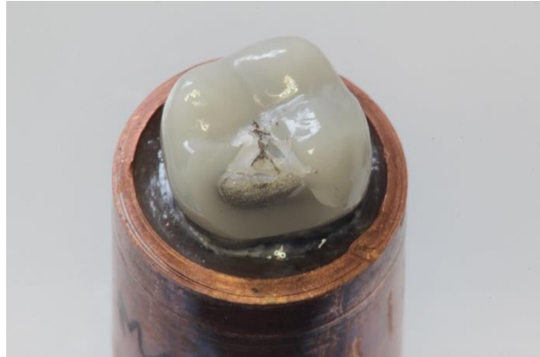
Abb. 16: Probe M11 nach Dauerbelastung: Bei 1800 N kam es zunächst zu Startschwierigkeiten. Im ersten Anlauf rutschte der Druckstempel ab, der zweite Anlauf wurde wegen einer Grenzüberschreitung automatisch abgebrochen. Im dritten Anlauf brach die Krone nach zwei Zyklen.
