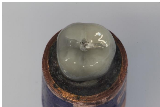
Abb 17: Probe M12 nach Dauerbelastung: Der Riss wurde bei 1804 Zyklen bemerkt. Auch im direkten Auflagebereich des Stempels zeigt sich eine deutliche Beschädigung der Krone.
