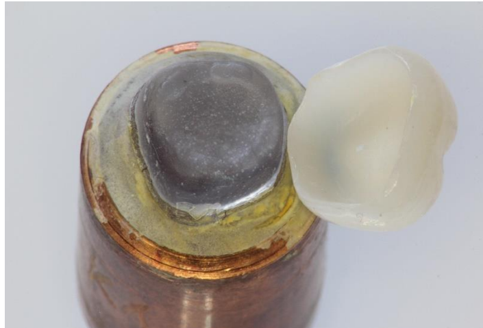
Abb. 13: Probe K1 nach Thermozyklierung. Im Rahmen der Thermozyklierung kam es zu einer Dezentementierung. Auf dem Bild ist deutlich zu sehen, dass der Befestigungskunststoff überwiegend auf dem Stumpf haftet. Am zervikalen Rand ist zu sehen, wie er sich leicht vom Stumpf löst.
