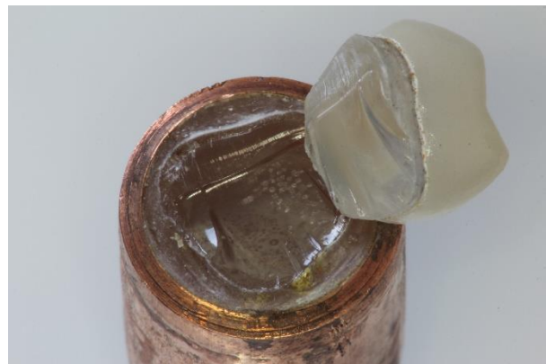
Abb. 29: Probe K9 nach Dauerbelastung: Bei einer Kraft von 400 N (40 %) blieb die Krone nach 102311 Zyklen intakt, der Stumpf ist zervikal abgebrochen.
