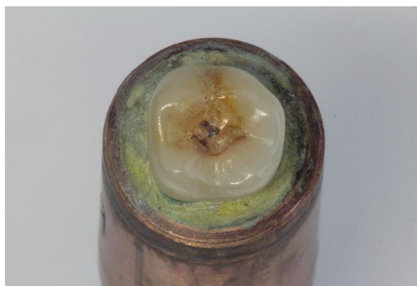
Abb. 39: Probe H9 nach Dauerbelastung: Bei 600 N (40 %) konnte diese Probe die 2 Mio. Zyklen unbeschädigt durchlaufen.
