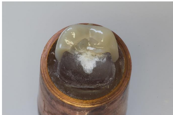
Abb. 33: Probe K27 nach Dauerbelastung: Bei 560 N (80 %) brach die Krone nach 1213 Zyklen. Auch im Stumpf ist ein kleiner Riss zu verzeichnen.
