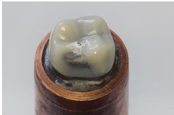
Abb 21: Probe M31 nach Dauerbelastung: Bei 1000 N (40 %) kam es nach ca. 400 Zyklen zum Bruch der Krone.
