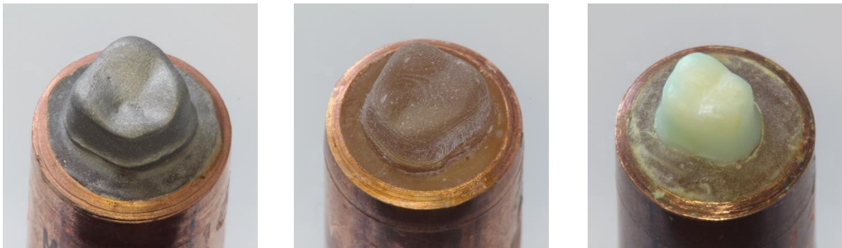
Abb. 8: Eingebetteter Metall-, Kunststoff- und humaner Stumpf (von links nach rechts).
