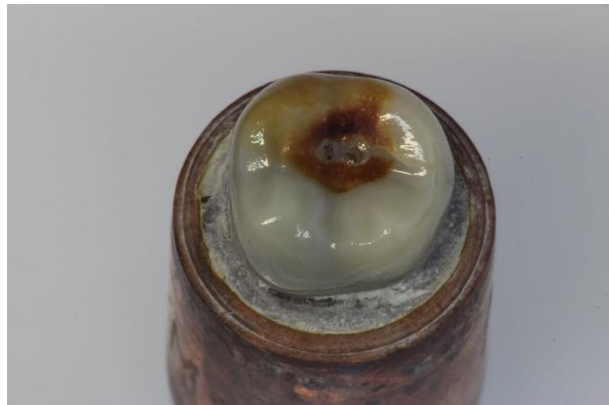
Abb. 23: Probe M37 nach Dauerbelastung: Nach 2 Mio. Zyklen bei 400 N wurde direkt vom Auflagebereich ausgehend ein kleiner Riss festgestellt. Da dieser Riss direkt vom Auflagebereich des Druckstempels ausgeht und sich nicht weiter ausgebreitet hat, wurde diese Probe als erfolgreich gewertet. Bei Probe M38 wurde ebenso verfahren.
