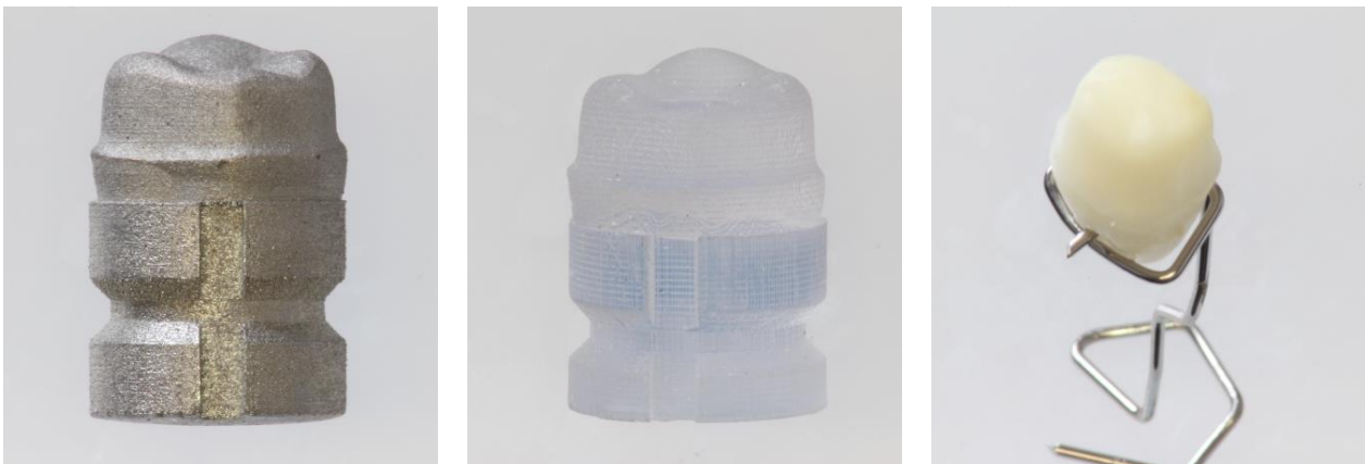
Abb. 6: Metallstumpf, Kunststoffstumpf und humaner Stumpf mit durchbohrter Wurzel und Draht-Halterung vor dem Einbetten (von links nach rechts).
