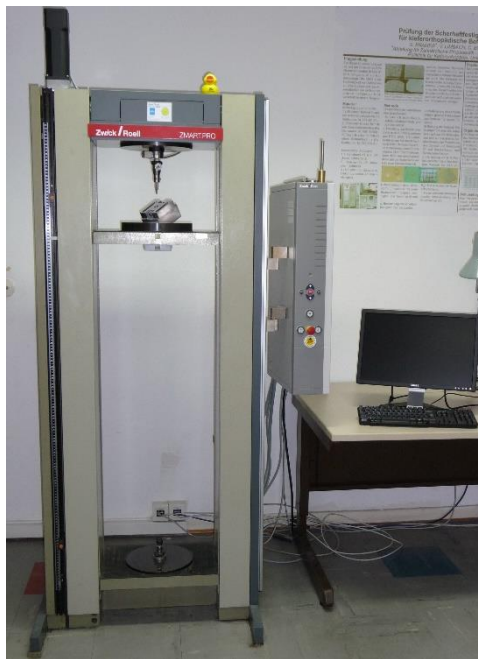
Abb. 9: Versuchsaufbau der Vorversuche: Links ist die Zwick Roell Zmart.Pro Type BZ1-MM14450.ZW03 Prüfmaschine (ZwickRoell GmbH & Co. KG, Ulm) zu sehen. Oben befindet sich der Druckstempel, der zum Schlitten ausgerichtet ist. Dieser ermöglichte die Ausrichtung der Probe zum Stempel in einem 30^\circ -Winkel. Eine Probe ist auf dem Bild nicht vorhanden. Die Steuerung der Universalprüfmaschine erfolgte über den Computer, der rechts im Bild steht.
