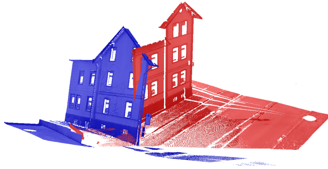
Abbildung 1.2: Beispiel einer Registrierung zweier Scans eines Gebäudes mit Abweichungen in den Registrierparametern \alpha und \beta .
