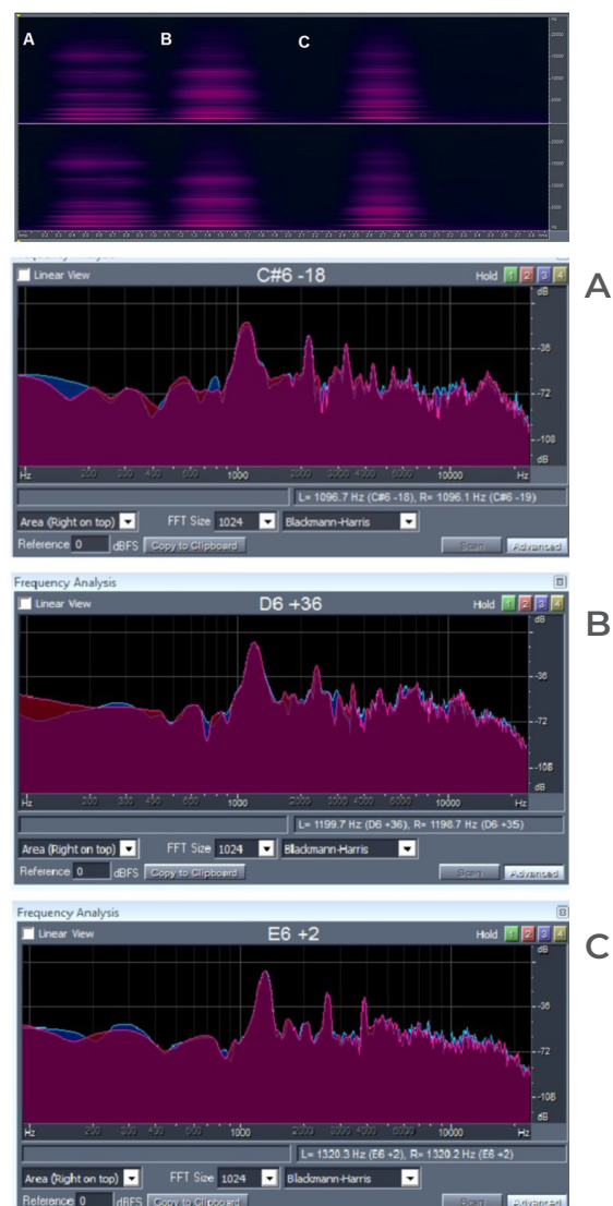
FIGURA 75. Gráficos espectrales de la producción sonora del único sistema acústicamente funcional de la flauta antropomorfa multifónica R01 del Museo BASA. A. Sonido emitido con los orificios de digitación obturados. B. Sonido emitido con uno de los orificios de digitación liberado. C. Sonido emitido con los dos orificios de digitación liberados.
