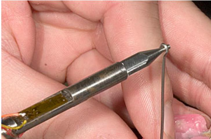
**Abb. 6:** Aufnahme eines Messvorgangs; Zur Vermessung der Abzugskräfte wird der Messstylus mit seiner Spitze in eine am Prüfkörper angebrachte Öse eingeführt.
