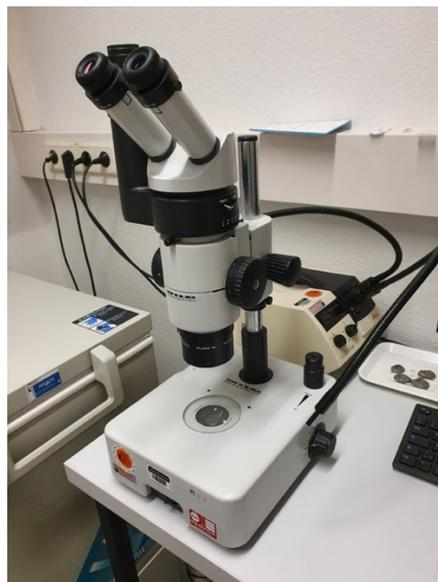
**Abb. 4:** Stereomikroskop Lupe Leica - Wild M8
