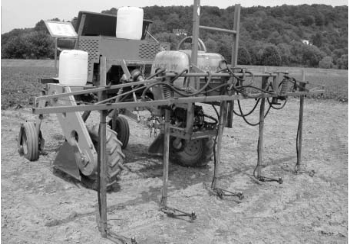
Abb. 1: Pflanzenschutzspritze zum Einsatz in Versuchen mit gleichzeitiger Oberblatt- (O) und Unterblattspritzung (U) und Kartoffelkrautteilern (T) (Einsatzort Wiesengut / Hennef).
