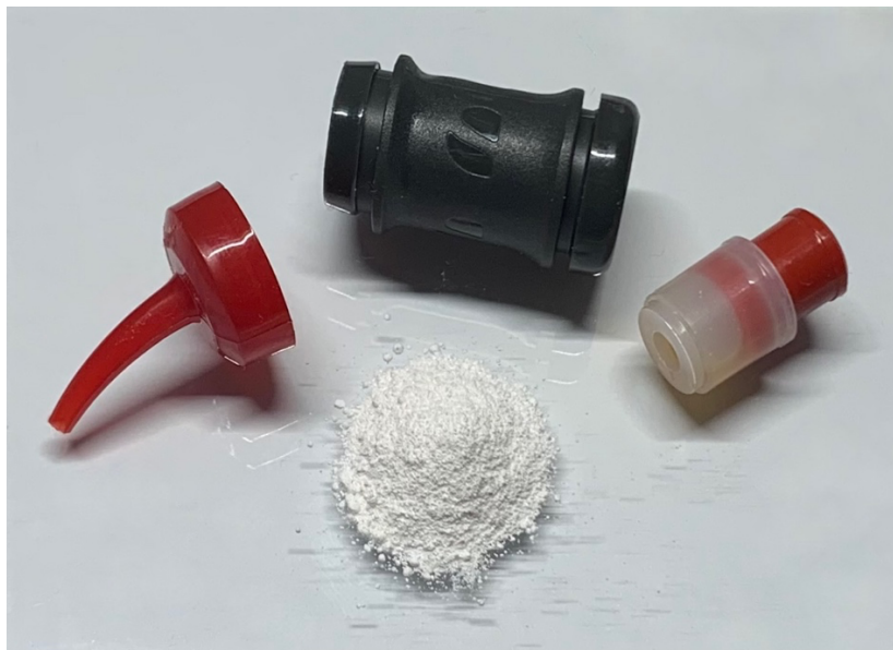
Abb. 1: Zusammensetzung der Mischkapsel von Surefil one TM
