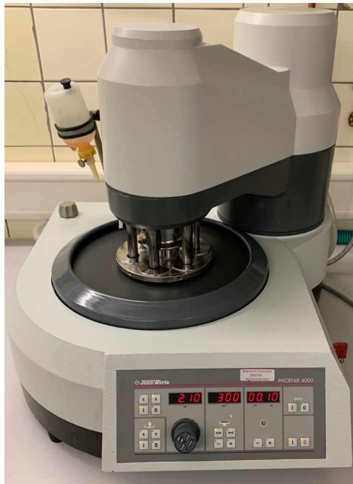
Abb. 8: Anrauen der Prüfkörper durch die Schleifmaschine Phoenix 4000
