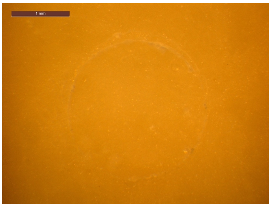
Abb. 20: Beispiel für einen Adhäsionsbruch (Prüfgruppe 2, Prüfkörper 3), Bruchverlauf entlang der Verbundfläche
