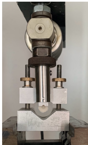
Abb. 18: Prüfspannvorrichtung mit angenäherter Scherklinge eingebracht in der Zwick Universal-Abzugsmaschine
