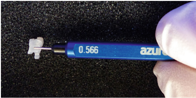
Fig. 3 Measurement of the slot size using a pin gauge Abb. 3 Messung der Slotgröße mit einem Lehdorn
