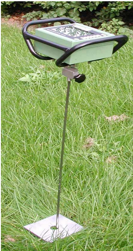
Abb. 7: Penetrologger zur Messung des Eindringwiderstandes
