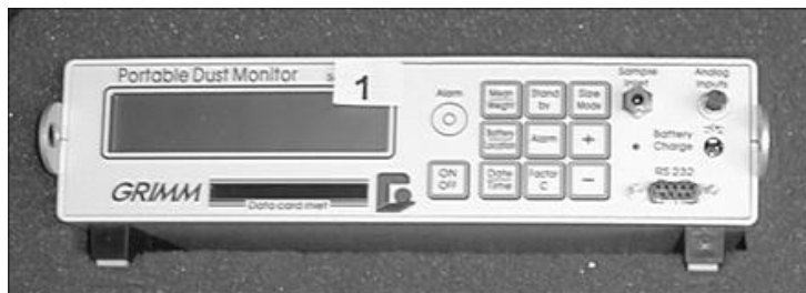
Abbildung 11: Ansicht eines Streulichtspektrometers der Firma GRIMM Aerosoltechnik GmbH
