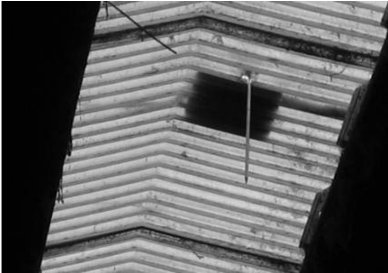
Abbildung 41: Messaufbau zur Bestimmung der Partikelkonzentration in den freigelüfteten Ställen mit Blick vom Futtertisch in den First
