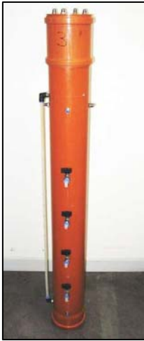
Abb. 3: Reaktionsbehälter der Pilotanlage (Frontansicht)
