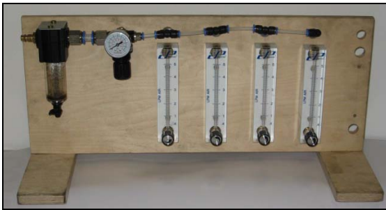
Abb. 4: Apparatur zur Regelung des Gasdurchflusses im Technikum
