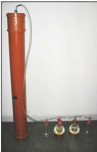
Abb. 5: Saurer Gaswäscher zur Ammoniakabsorption im Technikum
