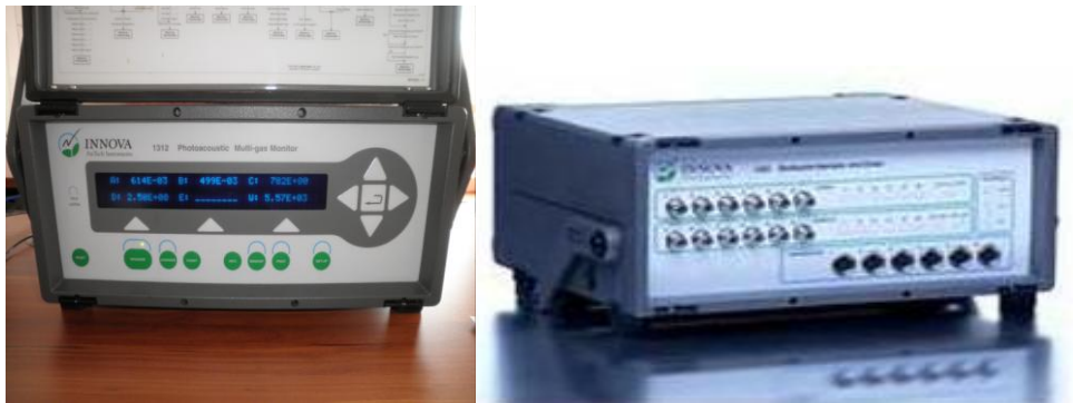
Abbildung 3.7: Multigasmonitor 1312 und Messstellenumschalter 1309 (rechts)
