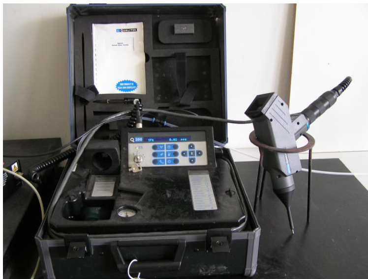
Abbildung 3.10: \text{SF}_6 -Detektor (HENSELER-PABMANN, 2010)
