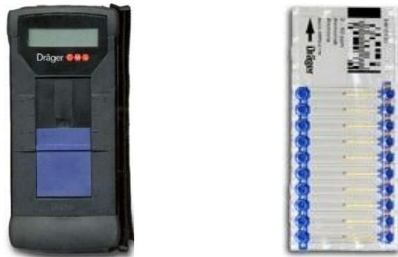
**Abbildung 27: Dräger CMS (links), CMS Chip (rechts)**
