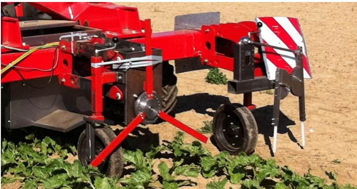
**Abb. 19: Rotations- (links) und Schwinghacke (rechts), die über Tasträder in der Höhe geführt werden**
