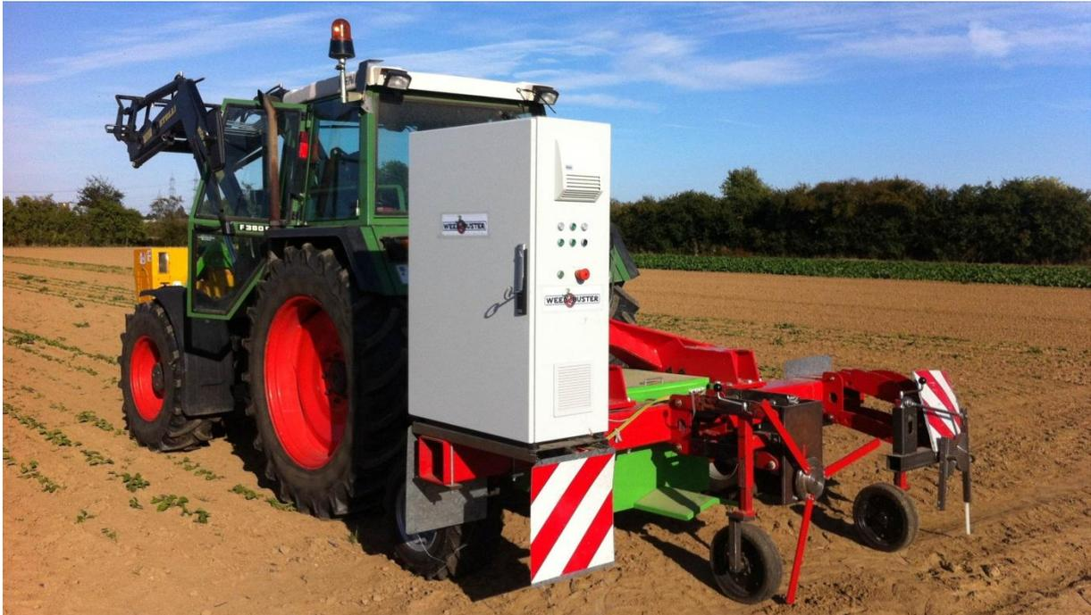
**Abb. 18: An einem Traktor angebauter Versuchsträger mit 2 Motoren, einer Box für Kameras und Beleuchtung (grün) und einem Schaltschrank zur geschützten Unterbringung der Mess- und Echtzeit-Rechner sowie der Servoumrichter und der restlichen elektronischen Komponenten**
