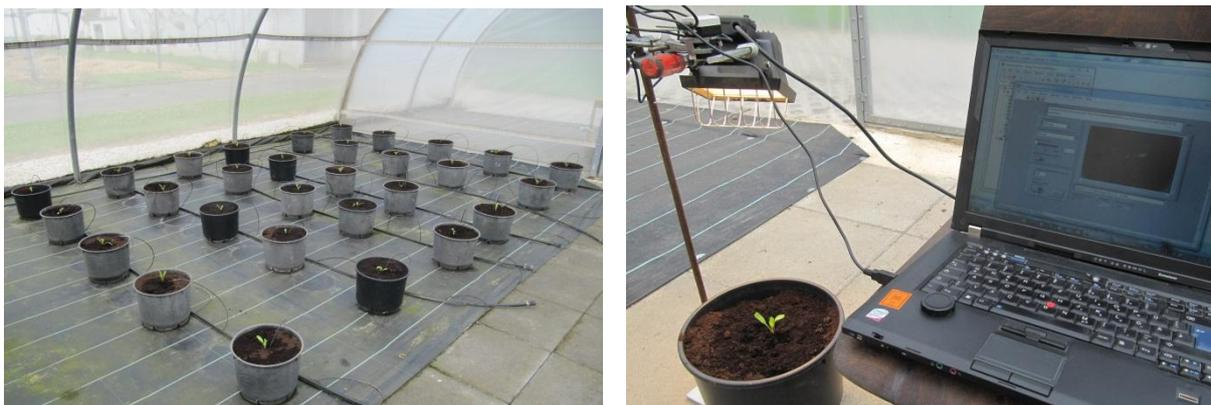
**Abb. 20: Pflanztopfversuche unter einem Wetterschutzdach (links), Versuchsaufbau mit Pflanze, Beleuchtung, CCD-Kamera und Notebook zur Bildakquisition**
