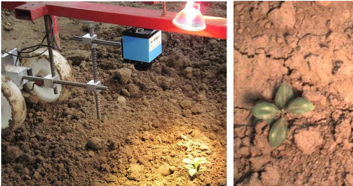
**Abb. 4: Bilderfassung mit einer CCD-Kamera auf der Bodenrinne (links) und Aufnahmeperspektive der Kamera (rechts)**
