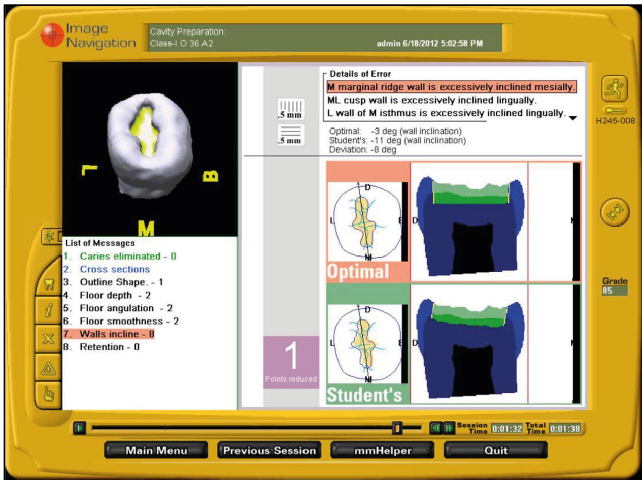
Abb. 14: Darstellung der Benutzeroberfläche des „DentSim“-Systems. In der oberen linken Ecke ist die fertige Inlay-Präparation abgebildet. Unten links werden die jeweiligen Bewertungskriterien aufgelistet. Auf der rechten Seite erkennt man im oberen Bereich die Fehleranalyse der Software sowie im unteren Bereich die ausgewählten Schnittbilder der Meisterpräparation und der studentischen Präparation (Dr. Samuel Elhadad - Image Navigation, 2024).
