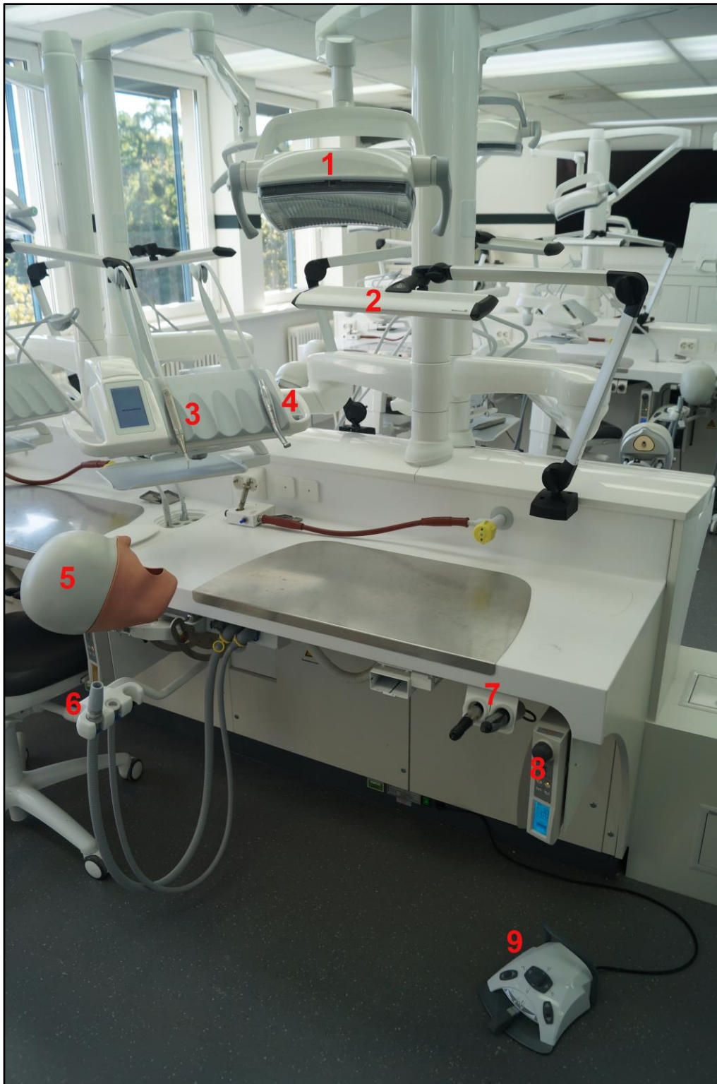
Abb. 23: Darstellung des Phantomarbeitsplatzes mit LED-Behandlungsleuchte (1), LED-Arbeitslicht für zahntechnische Arbeiten (2), Wasser- und Luftpüster (3), Mikromotor und Winkelstück (4), Phantomkopf mit Halterung und bereits angelegter Gummimaske (5), Absaugschläuche (6), Luftpüster und Handstück für zahntechnische Arbeiten (7), Kniepedal zur Drehzahlanpassung des Handstücks (8) sowie Fußpedal zur Drehzahlanpassung des Winkelstücks (9).
