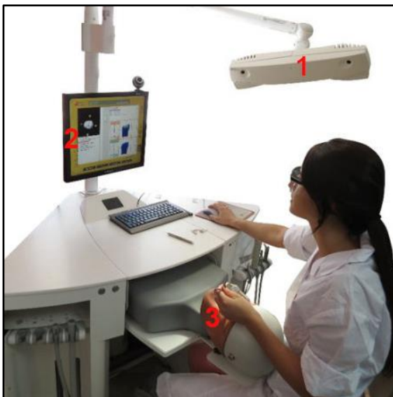
Abb. 13: Darstellung einer „DentSim“-Einheit bestehend aus einer CCD-Infrarot-Kamera, die der Aufnahme der Behandlungsschritte des Anwenders dient (1), einem Bildschirm mit „DentSim“-Benutzeroberfläche (2) und einem Phantomkopf mit Dentalmodellen (3) (Dr. Samuel Elhadad - Image Navigation, 2024).
