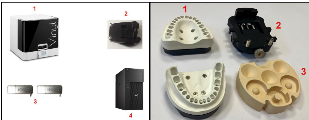
Abb. 6: Übersicht über die Bestandteile des „Dental Teacher 4.0“-Systems im Bild links: Desktopscanner der Firma Smartoptics (1), Universalmodellhalter (2), 2 USB-Sticks mit „Dental Teacher 4.0“-Software und Lizenz (3), Workstation (4). Bild rechts: KaVo-Modellhalter für das KaVo-Pinsystem der KaVo-Studienmodelle (1), Universalmodellhalter (2) und Kalibrierungskörper (3) (Kavo Dental GmbH, 2021).
