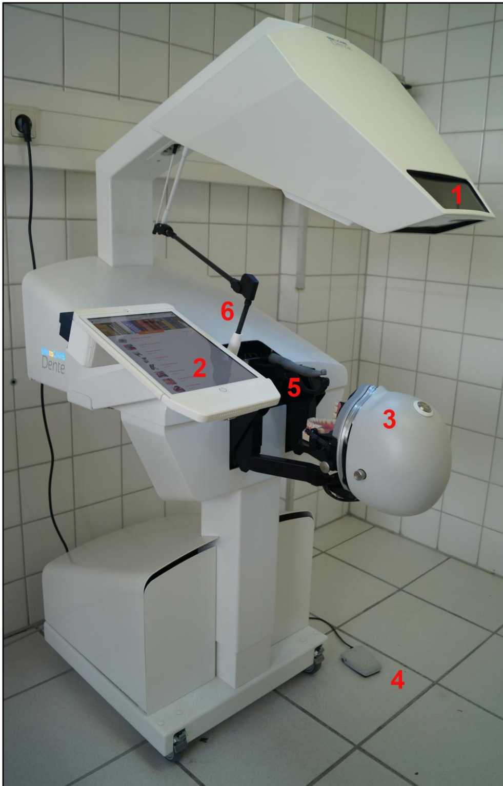
Abb. 15: Darstellung des „Dente“-Simulators der Firma SIMtoCare mit 4k 3D-Display (1), Tablet (2), Phantomkopf mit Dentalmodellen (3), Fußpedal (4) sowie einem Winkelstück (5) und einem Griff für einen zahnärztlichen Spiegel (6).
