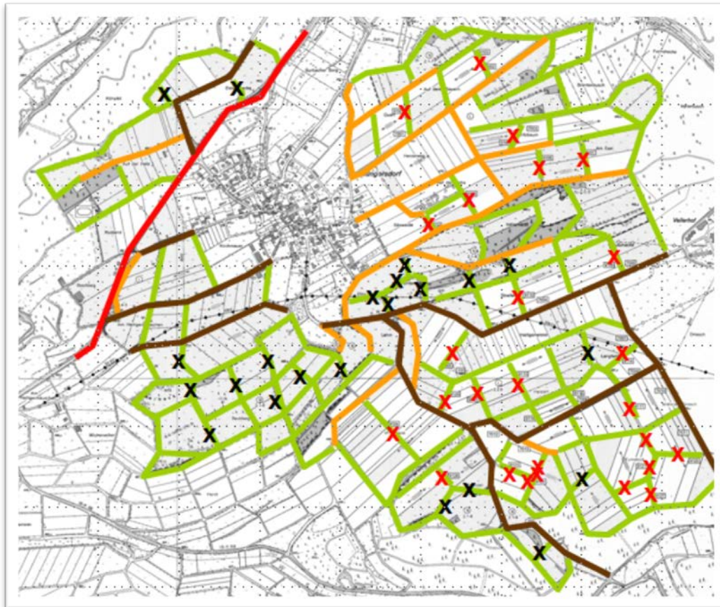
Abbildung 4.7: Flurbereinigung Hüngersdorf, Konzept zur Neugestaltung des Wegenetzes: grün: bestehende unbefestigte Wege; x, x: Rückbau bzw. Renaturierung bestehender Wege, (Quelle: Bezirksregierung Köln, Dezernat 33, 2011)
