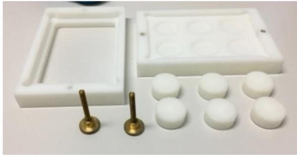
**Abb 2:** Dehnungsapparatur bestehend aus zwei Platten, sechs Dehnungsstempeln und zwei Schrauben. Die sechs Stempel werden auf die Platte mit den sechs Vertiefungen gesetzt. Darauf wird die 6 Well Zellkulturplatte mit der dehnbaren Membran platziert. Die obere gefensterte Platte wird über zwei Schrauben mit der unteren Platte fixiert. Das Ausmaß der Zell-Dehnung wird über die Dicke der Stempel definiert.
