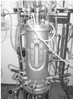
Abb. 116: Anzucht-Bioreaktor (Fermenter) des modern eingerichteten Biotechnikums am Institut zur Gewinnung von Naturstoffen aus »extremophilen« Bakterien [Foto ca. 2010 Marlene Stein, IMBT Bonn , © E. Galinski]
