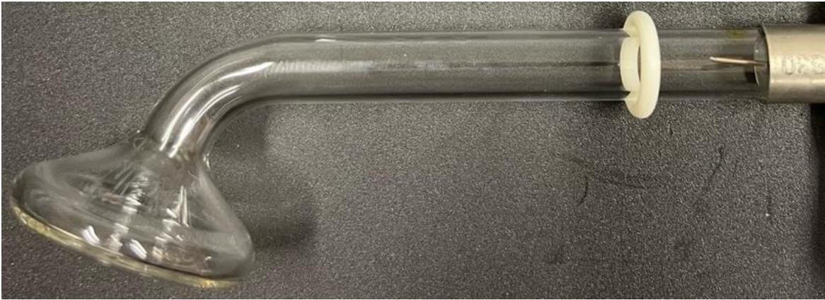
**Abb. 10:** Großaufnahme der Instrumentensonde PS 30.
