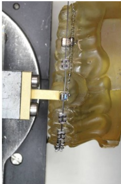
Abb. 17: Versuchsaufbau für die Reibungsmessung, hier beispielhaft an Zahn 13 mit Speed-Appliance-Brackets und NiTi-Bogen (modifiziert nach Szczupakowski, 2015).
