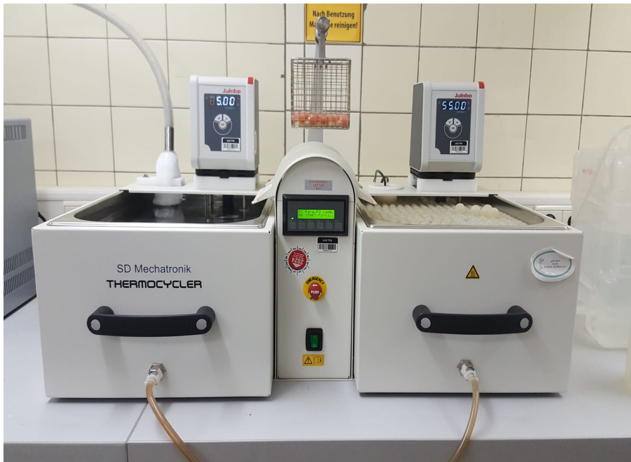
Abb. 17: Thermocycler (THE 1100, SD Mechatronik, Feldkirchen-Westerham) (Eigene Abbildung)
