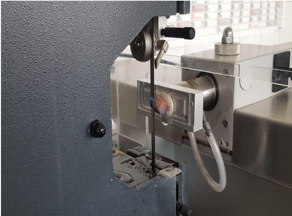
Abb. 19: Herstellung der Sägeschnitte (Eigene Abbildung)
