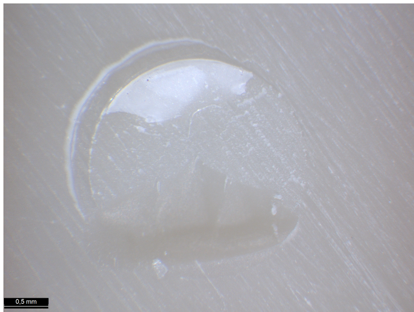
Abb. 13: Beispiel für einen Mischbruch Typ 3: Bruchverlauf teilweise adhäsiv, teilweise kohäsiv im Substrat, teilweise kohäsiv im Reparaturmaterial
