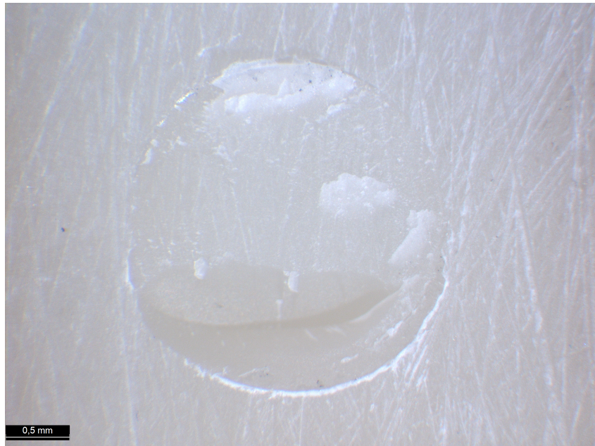
Abb. 12: Beispiel für eine Mischbruch Typ 2, Bruchverlauf teilweise adhäsiv, teilweise kohäsiv im Substrat
