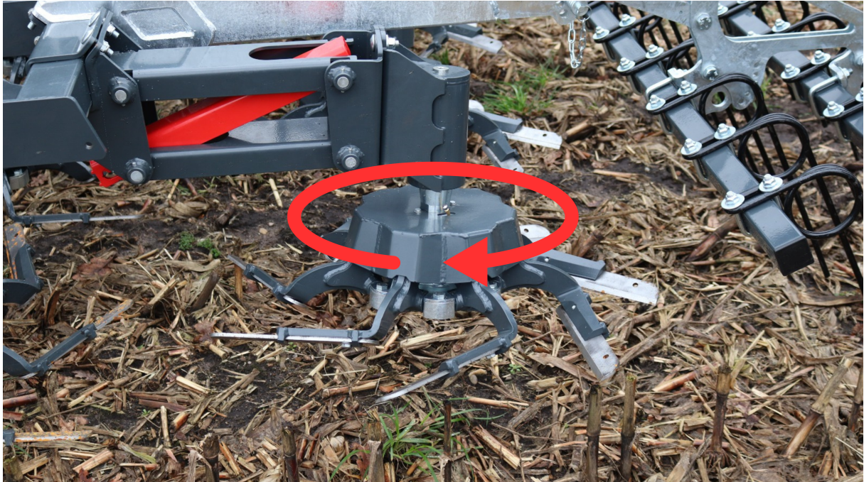
Abbildung 4.2: Wirkprinzip des Rotors und der Werkzeuge: angetrieben durch die Vorfahrtsgeschwindigkeit rotieren die entlang der X- und Y-Achse angestellten Rotoren, sodass die zur Rotorinnenseite geneigte Schnittkante Boden und pflanzliches Material bearbeitet.
