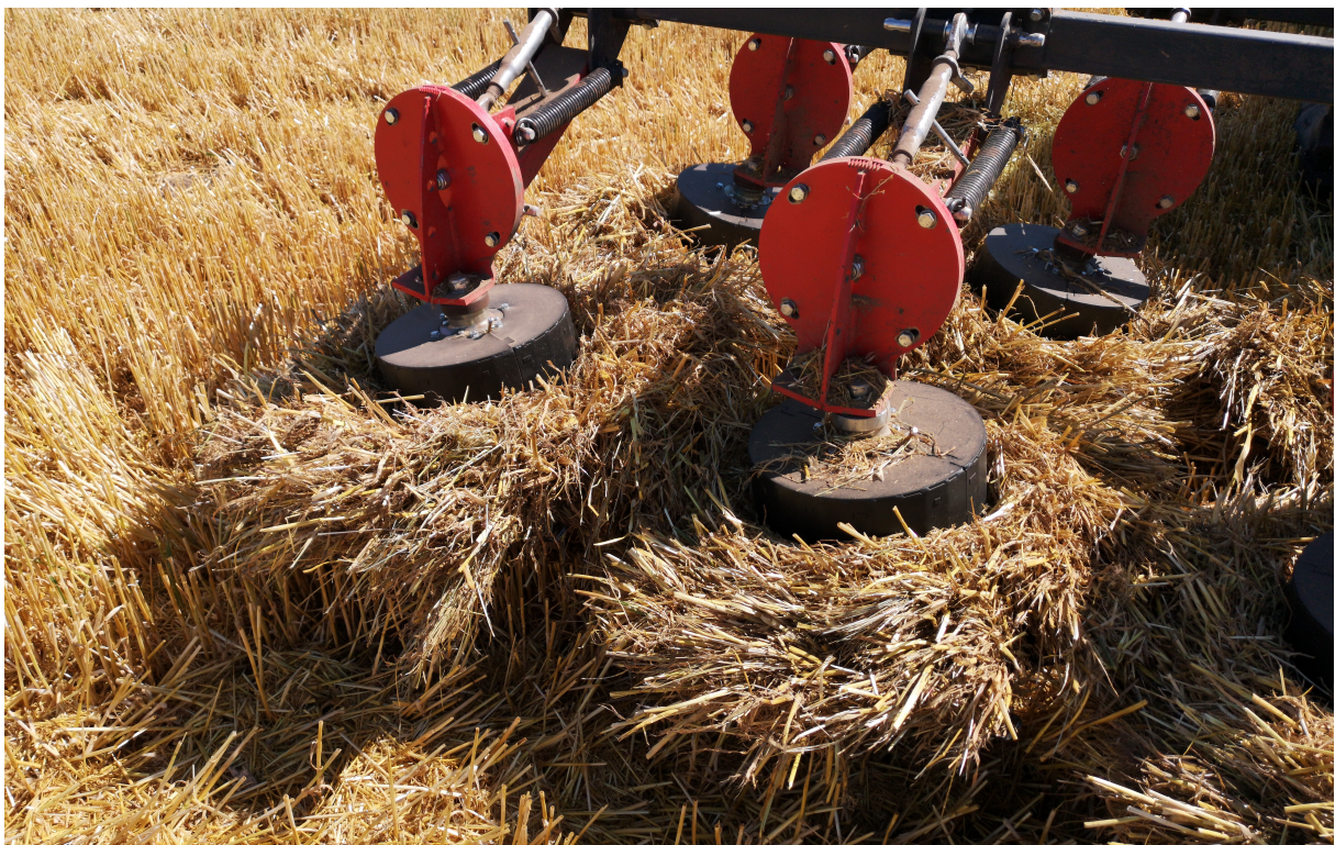
Abbildung 5.15: Aufgewickeltes Getreidestroh am Rotor des Rotationsschleifers Version 2
