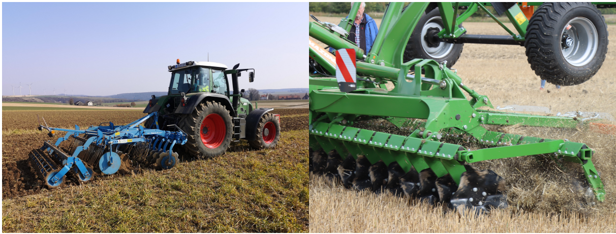
Kurzscheibenegge mit 620 mm Hohl-scheiben Kurzscheibenegge mit Spezialscheiben für ul- und Doppelwalze zur Tiefenführung traflache Bodenbearbeitung
