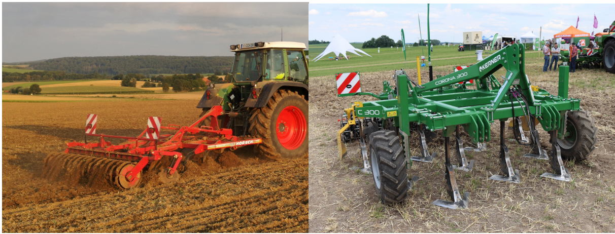
Zinkengrubber mit Federstempelwalze Mulchsaatgrubber mit Stützrädern zur Tiefenführung und Gänsefußscharen
