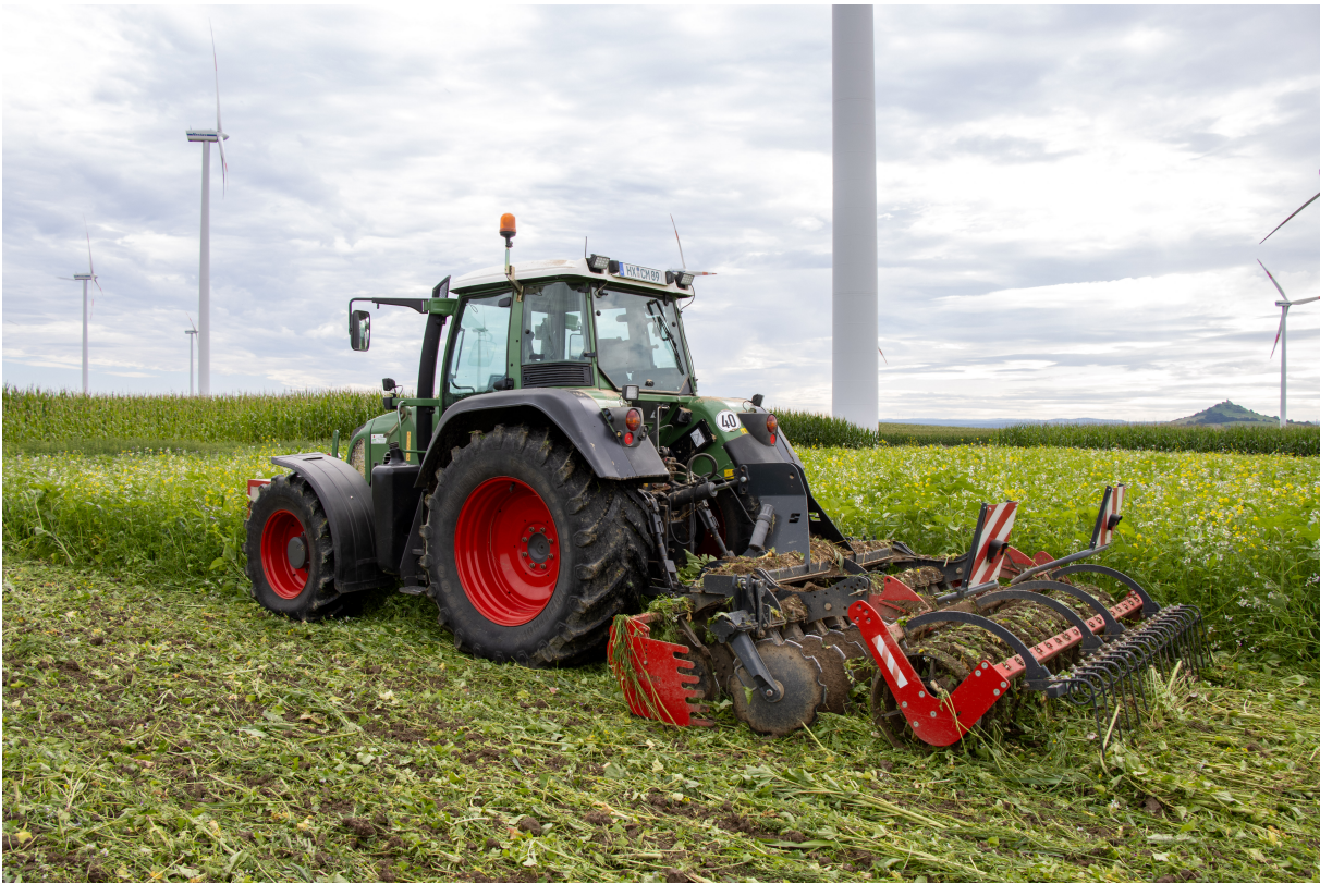
Abbildung 6.7: Umbruch einer biodiversen Sommerzwischenfrucht mit einer Kurzscheibenegge
