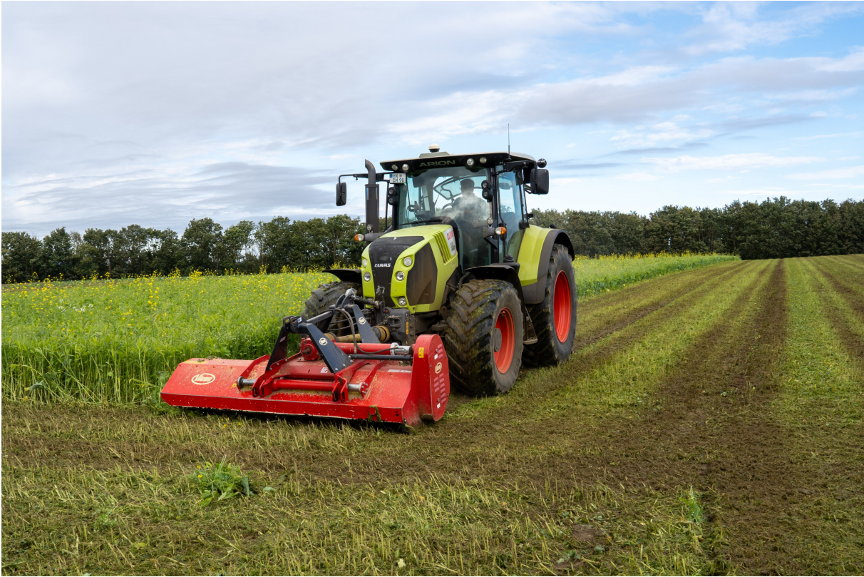
Abbildung 6.6: Zerkleinerung der oberirdischen Biomasse einer biodiversen Sommerzwischenfrucht mit einem Schlegelmulcher
