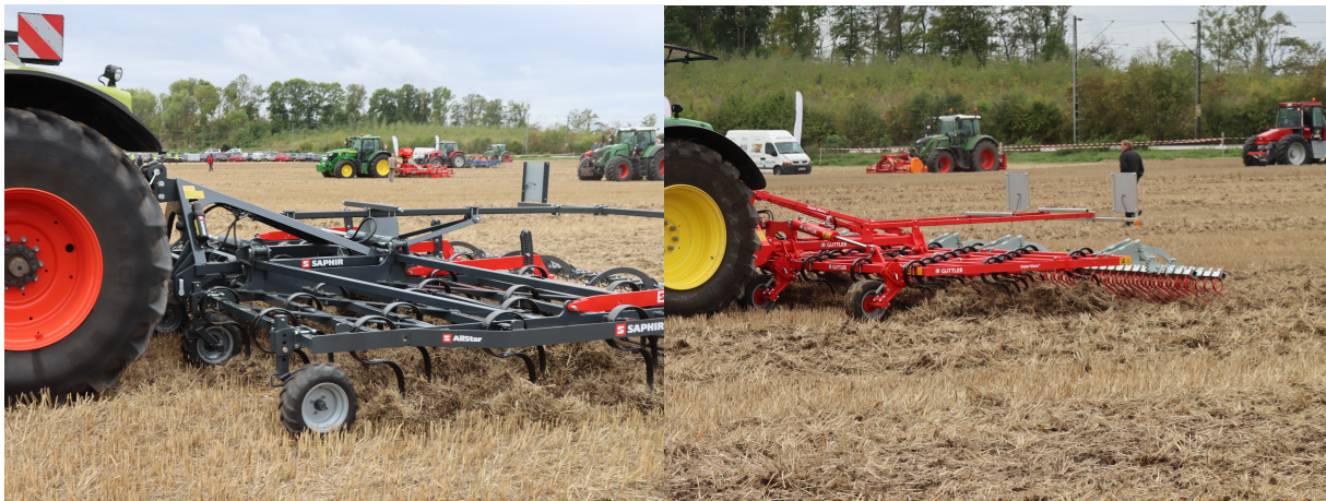
Großfederzinkenegge mit vorlaufenden Stützrädern zur Tiefenführung Großfederzinkenegge mit Doppelstriegel
