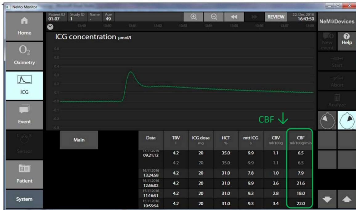
Abb. 4: Darstellung der RheoLity Software®, welche graphisch die Messung rund um die Injektion von ICG darstellt. Nach der Injektion steigt die Kurve (die optische Dichte des ICG) steil an um nach Erreichen eines Peaks langsam abzuflachen. Über die mean-transit-time wird der CBF und das CBV ermittelt. Quelle: Luciole Medical AG: [interne Geräteeinweisungspräsentation], PowerPoint-Präsentation, Bonn 2019
