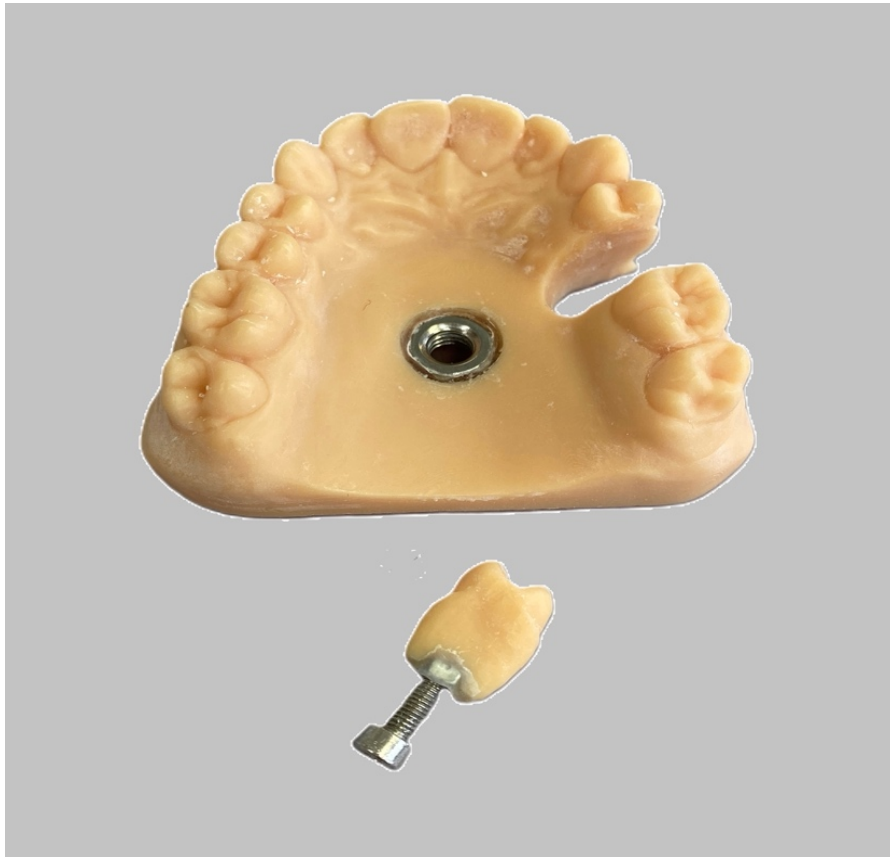
Abb. 4: Das angefertigte Modell mit dem herausgetrennten Zahn 25. Bereits versehen ist das Modell mit einer in der Mitte befestigten Mutter und der Zahn 25 mit einer Schraube.
