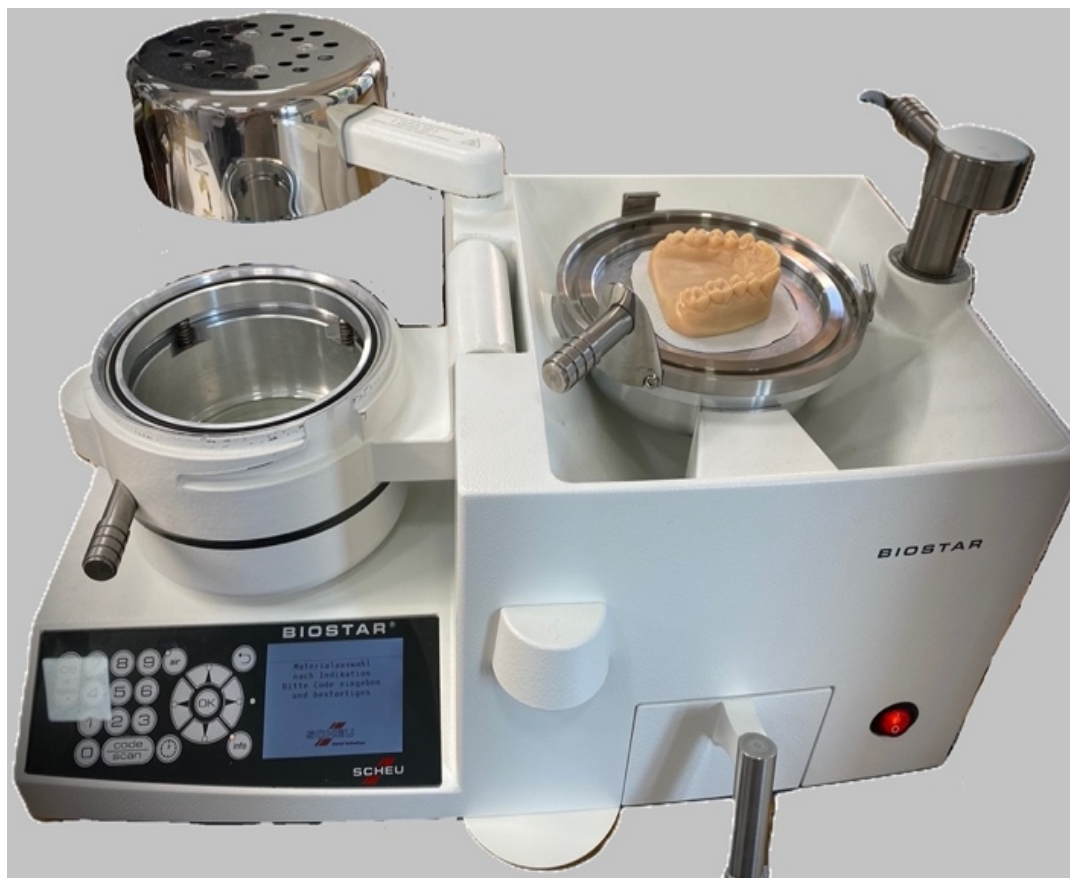
Abb. 2: Das Tiefziehgerät BIOSTAR® und rechts das Modell mit dem tiefgezogenen fertigen Aligner.
