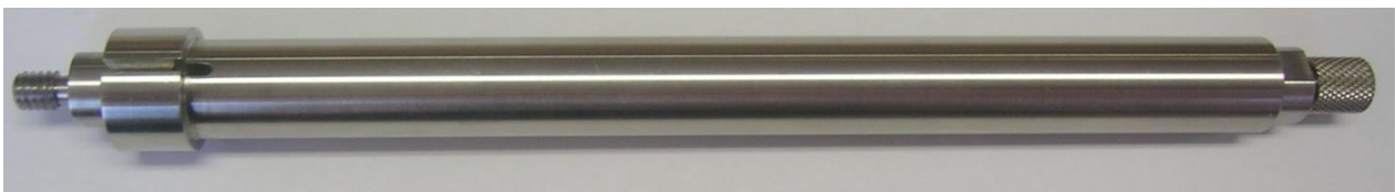
Abb.10: Aluminiumrohr mit Druckstempel links und Stellschraube rechts (mit freundlicher Genehmigung, Drolshagen, 2012).
