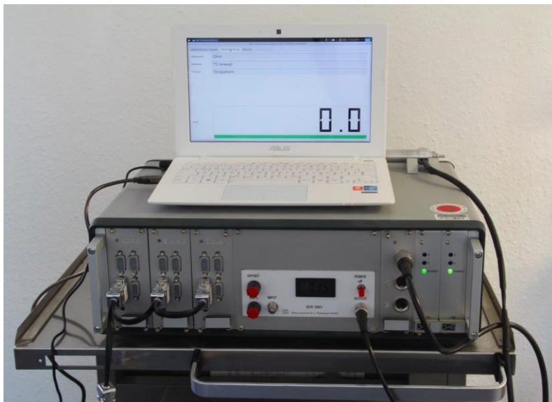
Abb. 11: Steuerrechner angeschlossen an die Steuereinheit mit den Mikrocontrollern Master (ADuC1), Slave1 (ADuC2) und Slave2 (ADuC3) (mit freundlicher Genehmigung, Gödecke, 2019)
