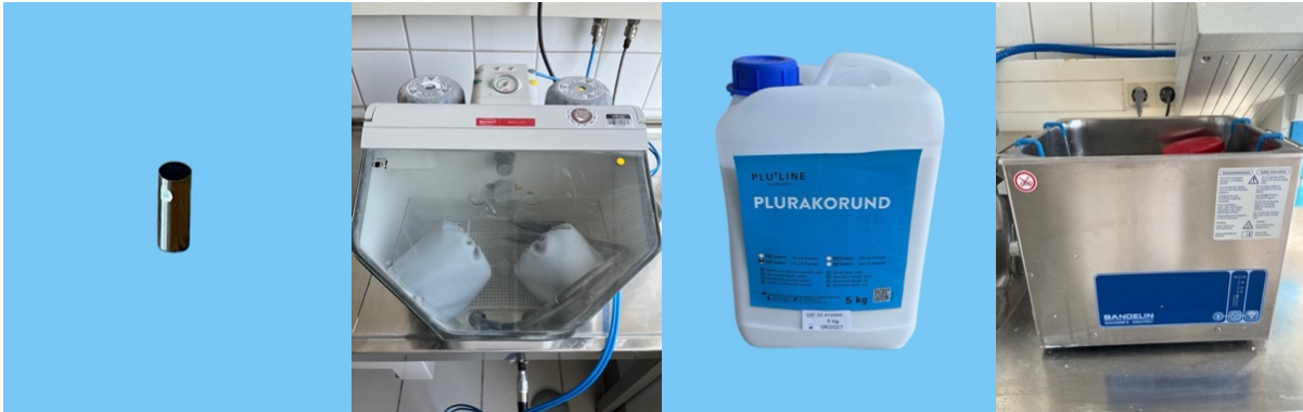
Abb. 7: Markiertes Metall-Stäbchen / Sandstrahler (Renfert, Hilzingen) / Edelkorund (dental bauer GmbH, Tübingen) / Ultraschallbad (BANDELIN electronic, Berlin) (eigene Fotos)
