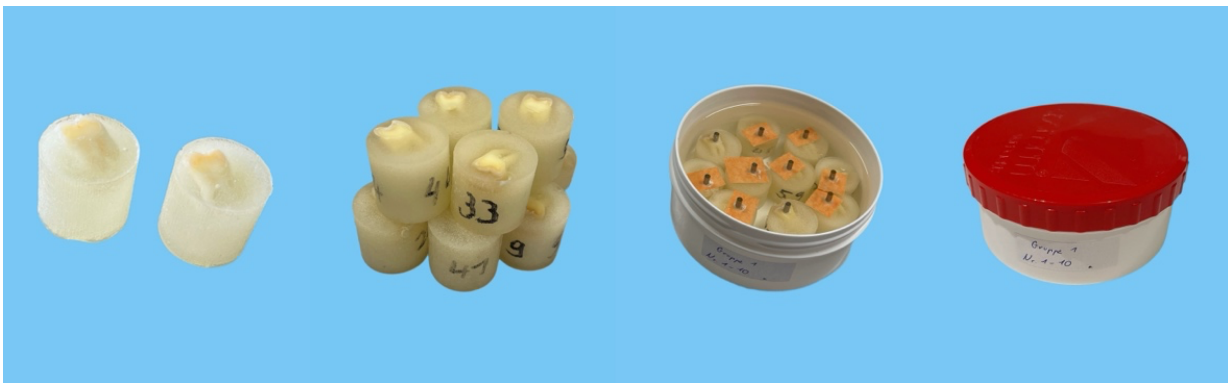
Abb. 6: Zahnblock nach dem Ausbetten / Beschriftete Zahnblöcke / Proben im mit Wasser gefüllten Schälchen (eigene Fotos)
