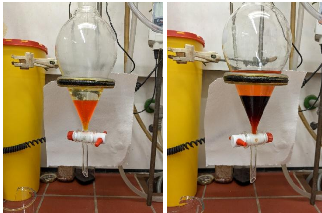
Abbildung 4.9: Farbumschlag von orange (links) nach dunkelrot (rechts) während der wässrigen Aufarbeitung zu Strebe 29 . (Die Abbildung wurde der vorangegangenen Masterarbeit entnommen. [50] )
