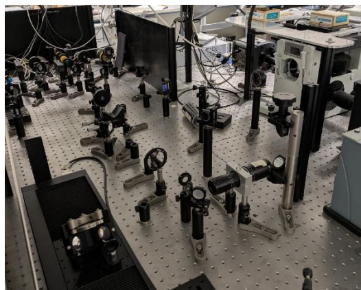
Abbildung 8.14: Aufbau zur Einzelmolekülfluoreszenzspektroskopie. Oben: Schematischer Aufbau. In Gelb ist der Strahlengang des Lasers dargestellt. In Rot ist die von der Probe ausgehende Photolumineszenz dargestellt. Unten: Foto des Versuchsaufbaus.
