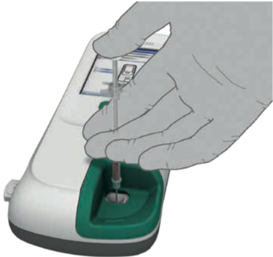
Abb. 5: Verwendung des Roche cobas h232 POC-Systems Teil 2 („Kurzbedienungsanleitung cobas h232 POC System“ von Roche). Nach Einführen des Teststreifens wurden 150 Mikroliter Urin auf das Probenauftragsfeld des Teststreifens aufgetragen. Anschließend wurde der Test gestartet.
