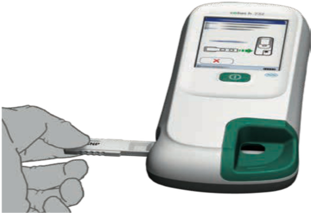
Abb. 4: Verwendung des Roche cobas h232 POC-Systems Teil 1 („Kurzbedienungsanleitung cobas h232 POC System“ von Roche). Nach Einschalten fordert das Gerät den Benutzer auf einen Teststreifen in die dafür vorgesehene Öffnung einzuführen.
