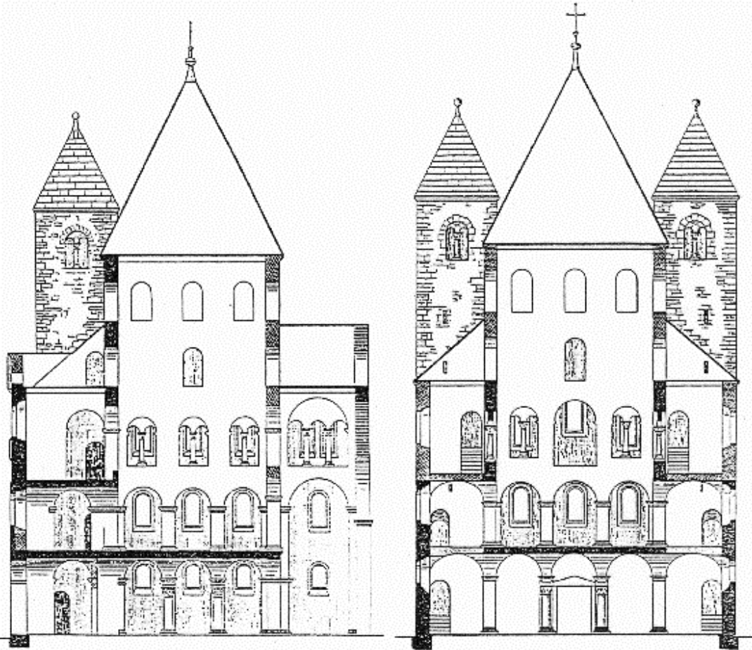
Abb. 13: Aufrißrekonstruktionen der Corveyer Westanlage nach Effmann. Aus: W. Effmann, Die Kirche der Abtei Corvey. Fuchs, Alois (Hg.). Paderborn 1929, S. 29.
