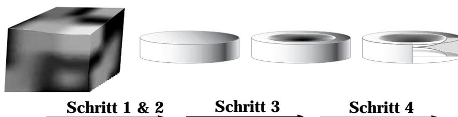
1. Bohren: Scheiben oder Stäbe mit mit 3mm Durchmesser werden mit einem Ultraschallbohrer ausgebohrt.
