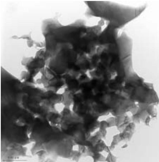
Abbildung 16.2: ZnO dotiert mit  $V_2O_5$ . Die Sintertertemperatur beträgt  $800^\circ\text{C}$ , die Sinterzeit 1h.
