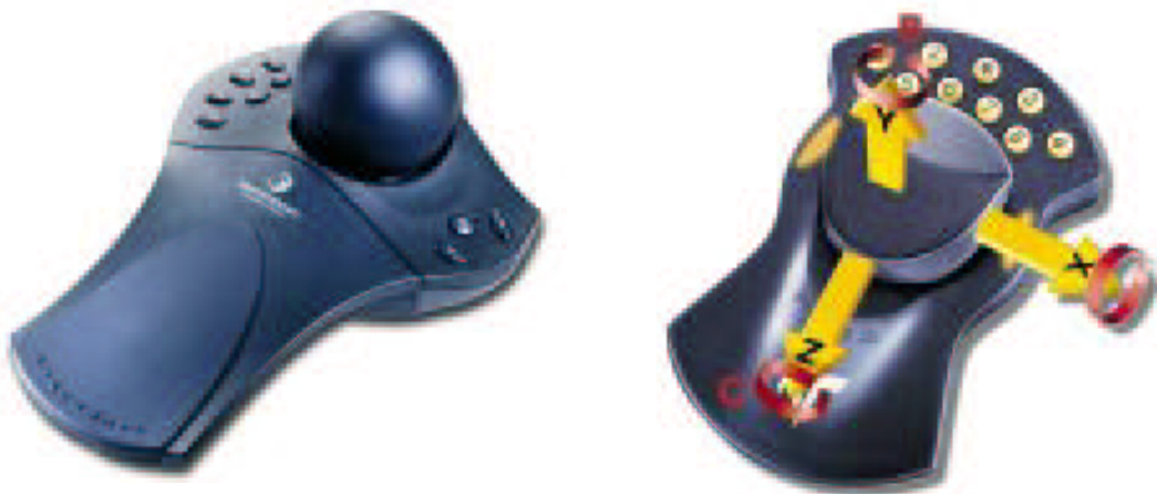
Abbildung 7.2: Der SpaceBall und die SpaceMouse der Firma 3Dconnexion sind speziell für die 3D-Desktop-Interaktion entwickelte Eingabegeräte.
