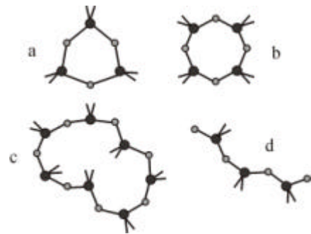
Abb. 4.6: Darstellung der fragmentalen Strukturmodelle im Quarzglas für a) Dreiering, b) Viererring, c) Agglomeration, d) Dreierkette. Die grauen Kugeln sind die O-Atome und die dunklen die Si-Atome.
