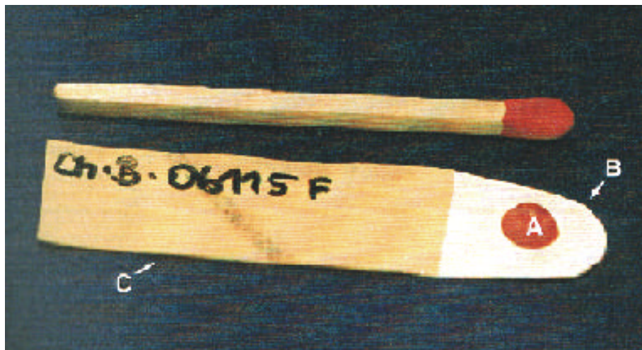
Abb.3.2: Dargestellt ist ein Lyophilisat (A), auf Methocel ® E4M-Basis (0,125 mg) mit Fluorescein-Natrium (0,250 mg) als Wirkstoff auf einem PTFE-Träger (B, Gewindeband, 100 µm) und einem Griff aus Autoklavierklebeband (C) [Foto: Grunthal, 1996]
