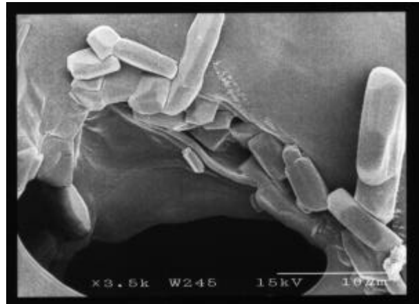
Abb.7.61: HPMC E4M-Lyophilisat 0,5 % (m/m), Pilocarpinhydrochlorid 1,6 % (m/m) in der Ausgangslösung (0,125 mg HPMC, 0,400 mg Pilocarpinhydrochlorid pro Lyophilisat) Vergrößerung 1:3500
