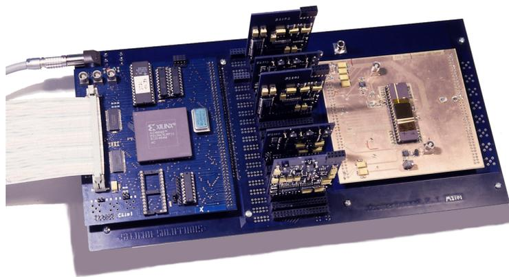
Abbildung 5.2: Photo des „Blue-Boards“. Der Aufbau ist unterteilt in drei Bereiche. Links befindet sich der FPGA, in der Mitte die „Slots“ mit einigen Steuerkarten, rechts befindet sich das Testobjekt. Das Flachbandkabel links ist mit dem PC verbunden.
