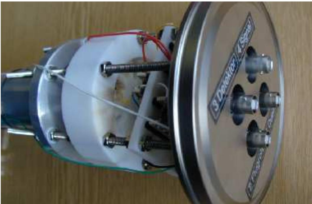
**Abbildung 2.12:** Ein ausgebautes TOF-MS mit Aluminiumrohr für die Driftstrecke, der Halterung und Spannungsteilerschaltung für den Detektor und den Hochspannungs- und Signaldurchführungen.
