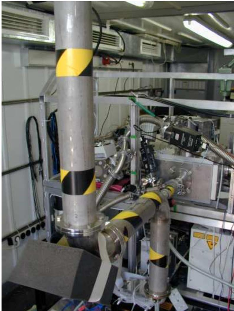
**Abbildung 5.2:** Strömungsrohrsystem zur Probenahme atmosphärischer Partikel im Laborcontainer (*Bläsner [2001]*).
