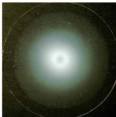
Abb. 29: Abdeckglas mit gewinkelter Aufbau beschichtet, rotierende Probe, Entladedraht nicht gedreht.
