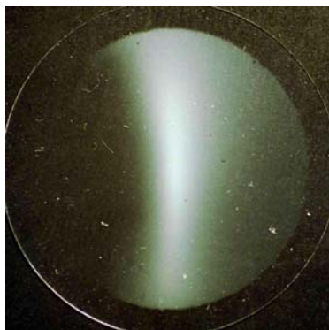
Abb. 28: Abdeckglas mit gewinkeltem Aufbau beschichtet, Target nicht gedreht.
