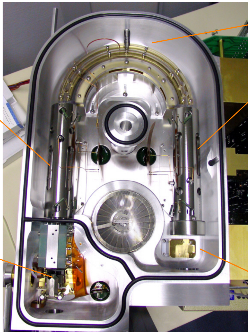
Abbildung 10. GC/MS/MS System (oberes Bild). Das untere Bild zeigt die Komponenten des Kodiak 1200 Triple-Quadrupol Massenspektrometers (Ansicht von oben in das geöffnete Gerät).
