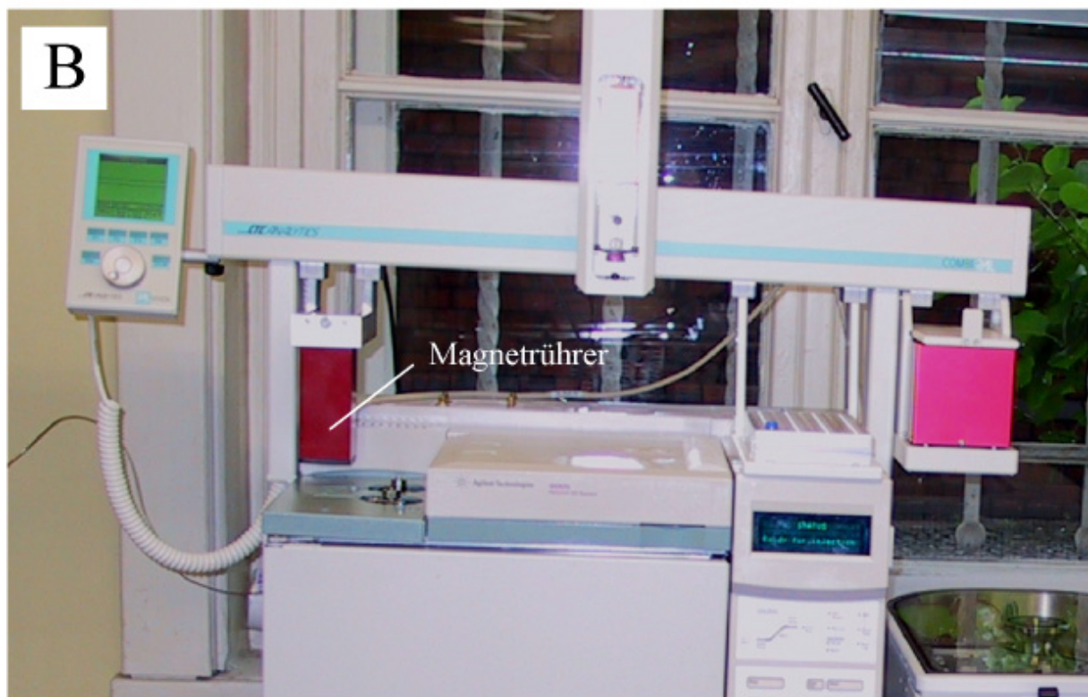
Abbildung 3. CTC CombiPAL Autosampler mit Agitator und SPDE-Gasstation (A), sowie mit zusätzlichem Magnetrührer (B).
