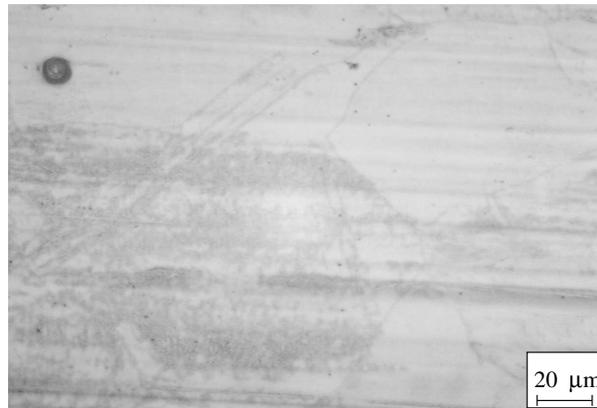
Abbildung 5.15: Mikroskopaufnahme der bei 650°C oxidierten mechanisch polierten Probe G.
