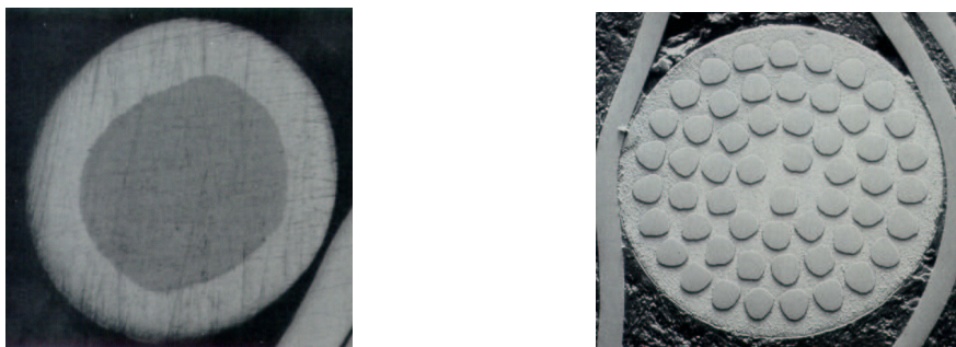
Abbildung 7.2: Vergleich von Single- und Multifilamentleitern. Die Aufnahmen stammen von der Firma Supercon, Boston MA.
